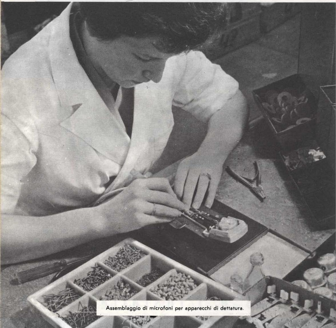
Assemblaggio di microfoni per apparecchi di dettatura.
